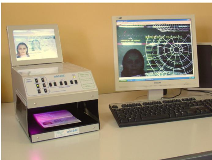
*Doté d'une sortie vidéo, l'équipement sera utilement complété par un micro-ordinateur (portable) doté de notre logiciel ForenPix pour l'enregistrement des images, et la comparaison des images obtenues en infrarouge ou sous ultraviolet avec les images authentiques fournies par une base de données d'images de documents authentiques, l'application de décodeurs d'images latentes (ci-dessous), etc.*
