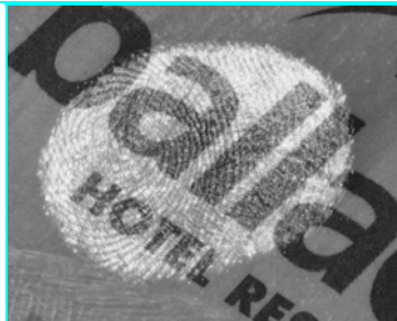
Un effet de fluorescence sous UV donne un contraste à la trace, mais pas suffisamment pour la rendre identifiable.
