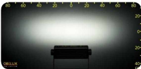
CR9-UWV-A1 Lentille ovale 12° x 45°, couleur blanche. (Distance de la paroi : 1 m)
